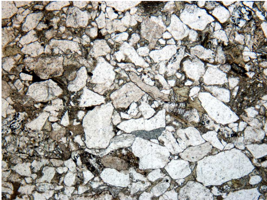
Abbildung 28: Die Laas Formation zeigt typischerweise ein helles Erscheinungsbild, mäßige Sortierung, subgerundete bis kantige Körner mit einer Größe von 0,1 bis 2 mm. BB: 3,2 mm, // Nic.
