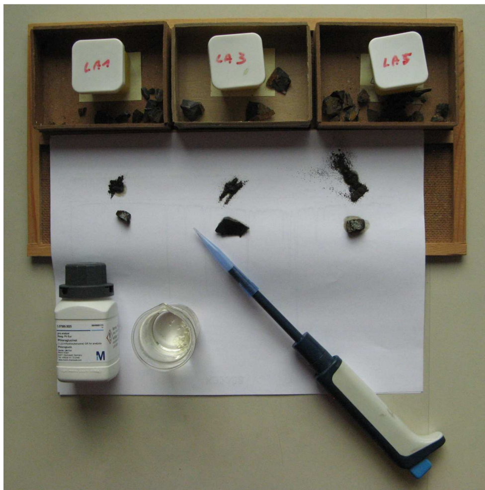
Abbildung 38: Versuch des Lignin-Nachweises bei den Kieselhölzern. Es ist keine Verfärbung erkennbar.
