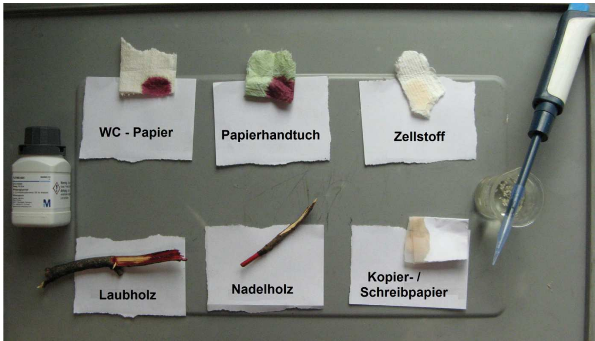
Abbildung 37: Der Test mit Ligninhaltigen und Ligninfreien Materialien zeigt: Der Nachweis funktioniert.
